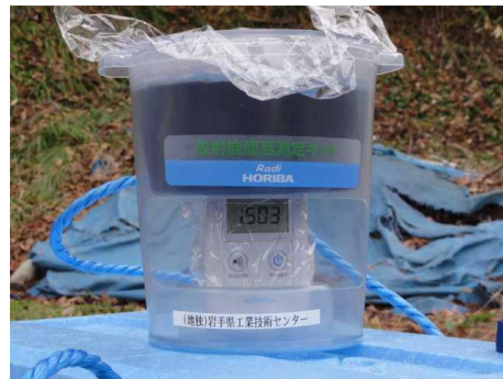
写真2 簡易測定キット PA-K (Radi PA-1000 をセットした状態)
