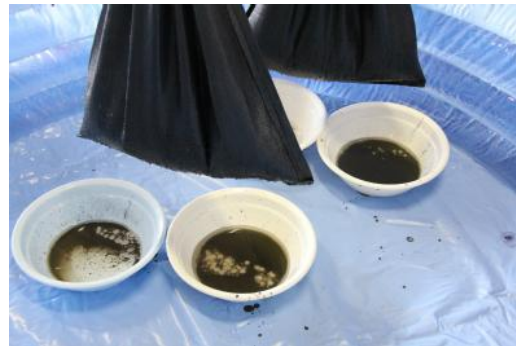
写真1 一般土のうによる脱水 (対照区)
