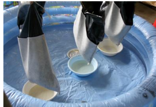
写真2 ゼオライト機能紙土のうによる脱水 (試験区1)
