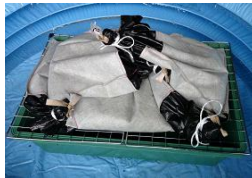
写真3 ゼオライト機能紙土のう横置き2段積みでの脱水 (試験区2)
