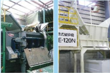
廃プラスチック類破砕機「MS1500」
