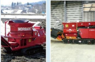
移動式木材破砕機「タブグラインダー1000」
