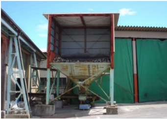
② 投入ホッパー ガラスびんを自動で投入します。
