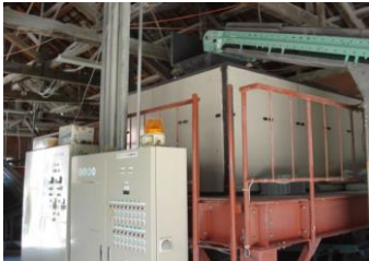
⑥ 二次破砕機 破砕したガラス粒の角を取ります。
