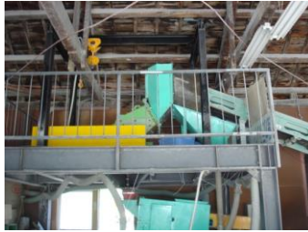
④ 一次破砕機 ガラスびんを破砕します。
