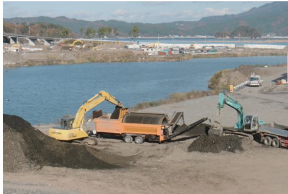
写真 3.5.3 分別土B種の製造状況（山田地区）
