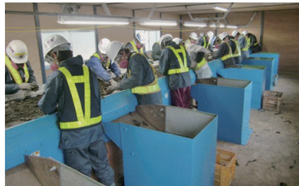
写真 3.5.2 選別処理の状況（左：大槌地区・回転選別機、右：釜石市・手選別）
