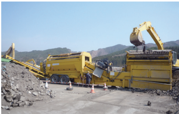
写真 3.5.2 選別処理の状況（左：大槌地区・回転選別機、右：釜石市・手選別）
