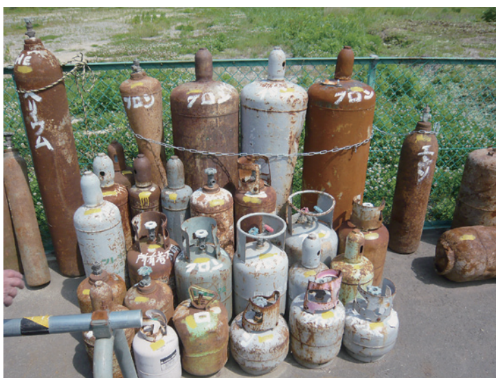
写真 3.13.4 高圧ガスボンベ
