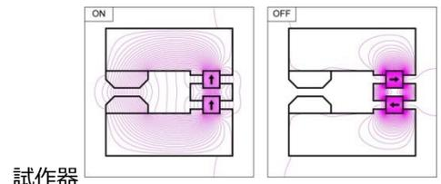
複数の磁石の方向を調整することで、磁場強度を調整することが可能な機構
