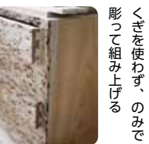
くぎを使わず、のみで 彫って組み上げる 木地の完成
