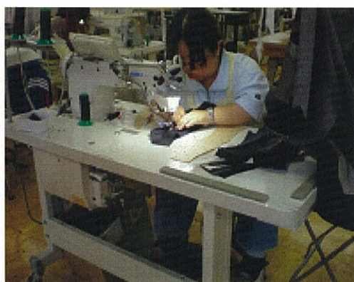
踏み板の高さを調節したミシンで縫製
