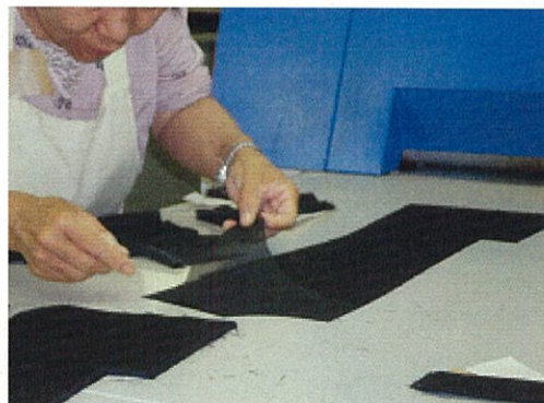
手際よく芯地を貼る作業を行っています。
