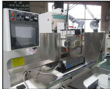
平面研削盤で加工
