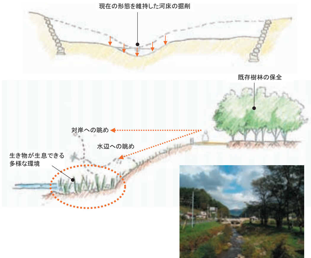
○水生生物への配慮が施された河床と保全された河畔林による自然豊かな河川が保たれている。（岩手県葛巻町・元町川）
