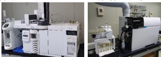
分析装置：GC-MS（左）、ICP-MS（右）
