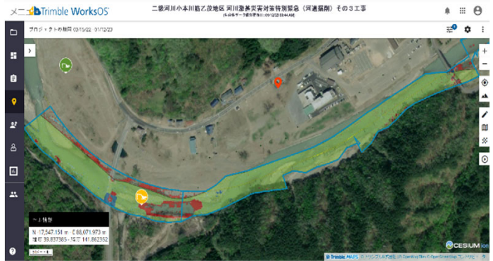
施工履歴データ(建機の位置、掘削進捗状況をリアルタイムで共有)
