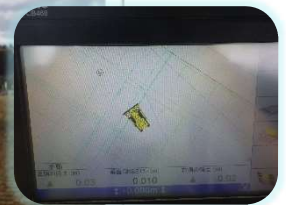
【MCブルドーザによる路体盛土の敷均し】
