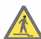
下り段差注意 Caution, uneven access / down
