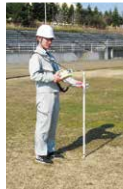
サーベイメータによる測定
