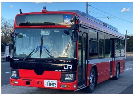
図 18 BRT 専用大型自動運転バス
