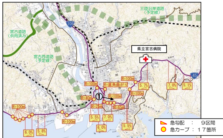
▲宮古病院周辺の国道45号構造の厳しい箇所（搬送患者の負担が大きい箇所）
