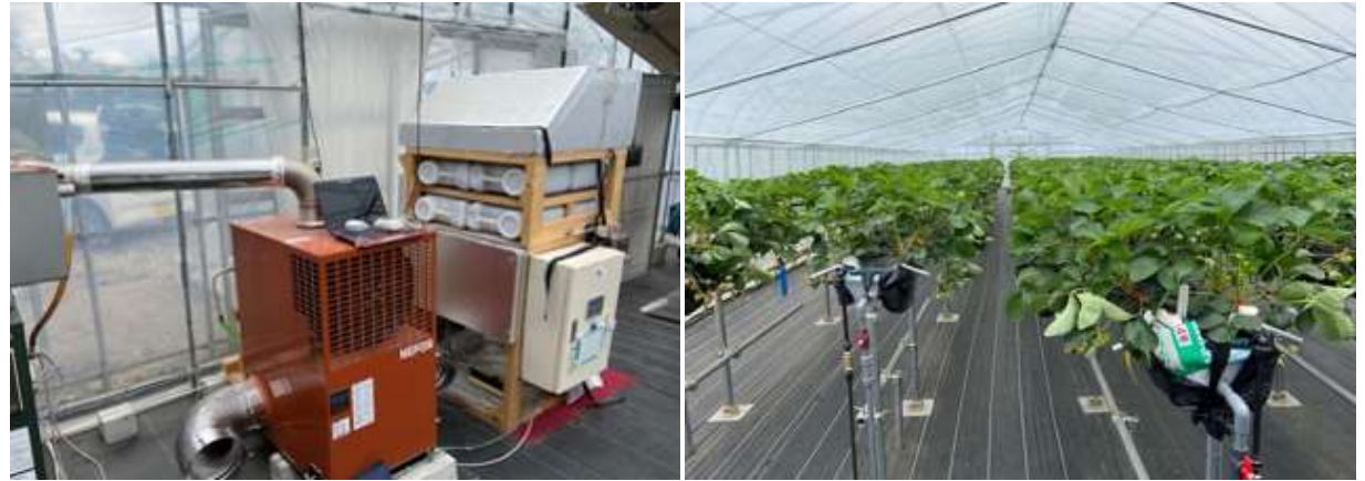
ハスクレイによる温泉の排熱利用のフィールド実験
