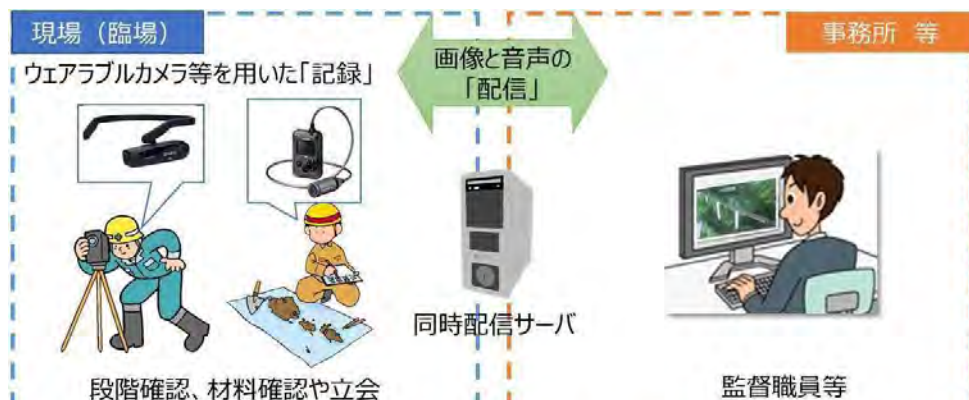
機器構成(例) 出典:建設現場の遠隔臨場に関する試行要領(案)(国土交通省 R3.3)
