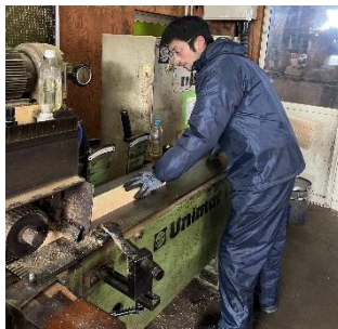
▲ モルダー作業の様子
