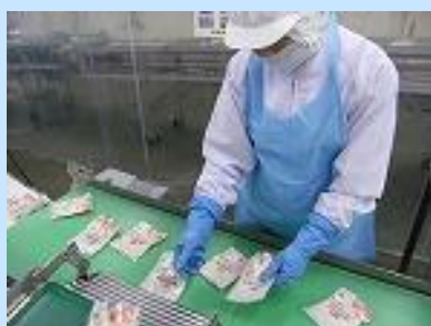
⑤ パック詰めされた製品を一つ一つ目視確認しているところ
