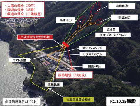
○ 今後の豪雨において発生し得る土石流を捕捉する砂防堰堤の整備により、下流の保全対象家屋20戸に対し被害を防止
