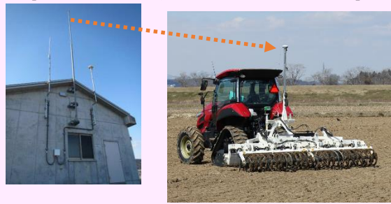
【揚水機場の基地局、GNSSレベラーによる均平作業】
