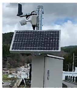
簡易型河川監視カメラ(県)
