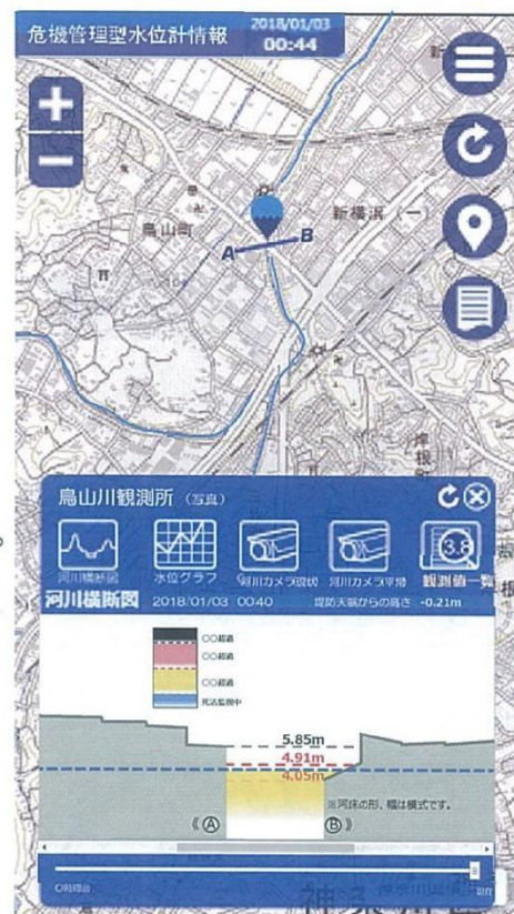
④水位計詳細画面（河川横断面図）
