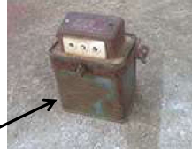
揚水ポンプの分電盤 に設置されていた 低圧コンデンサー
