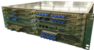
大容量高速光通信装置
