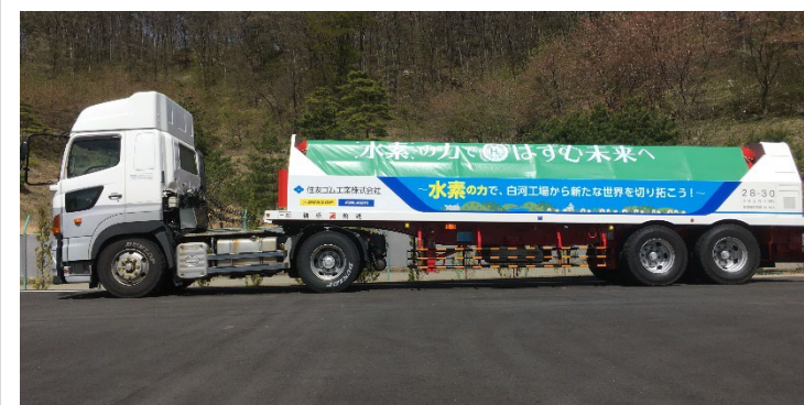
上：住友ゴム工業白河工場に設置した水素ボイラー 下：同工場へ水素を輸送するトレーラー
