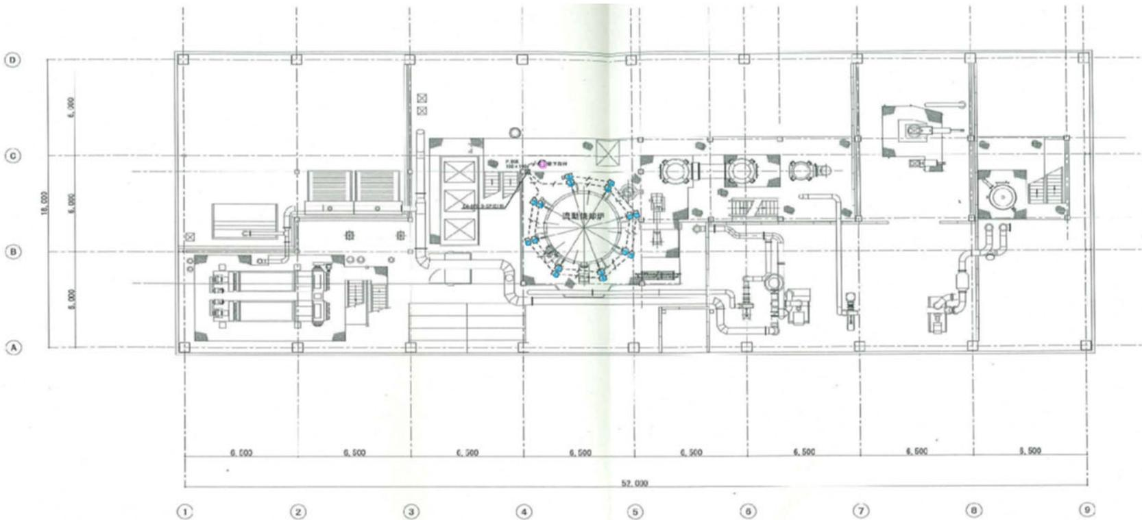
汚泥焼却炉棟 2 F L 平面図
