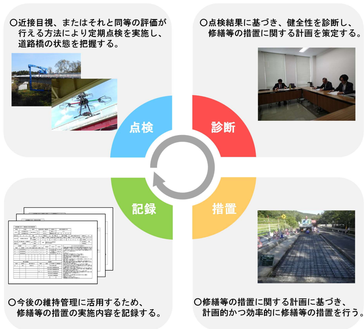
図 4-2 道路橋のメンテナンスサイクル
