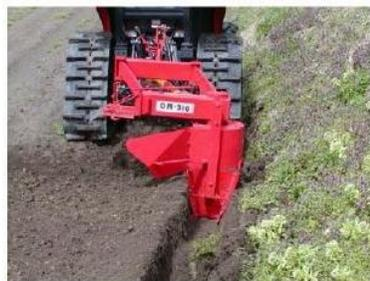
写真4 排水溝（額縁明渠）の設置
